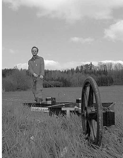
Fig. 9: Feuchtwiese im Umfeld der Deponie Riet in Winterthur. Ein grosses Wegmessrad erlaubt eine rasche Georadar Datenaufnahme in einem engen Raster.
