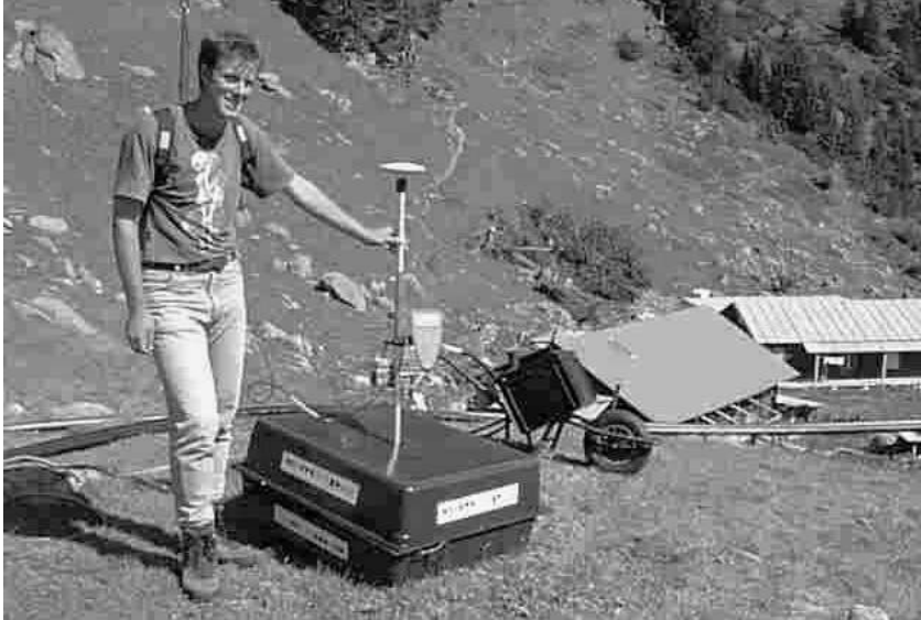
Fig. 5: Positionierung der Georadarantennen mit differentiellem GPS beim Bergsturzgebiet Chapf, Innertkirchen (ETH Zürich, Geodätischer Projektkurs).
