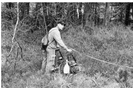
Fig. 7: Georadar in unwegsamem Gelände: Antennenführer mit Messband (Foto: P. Staubli).
