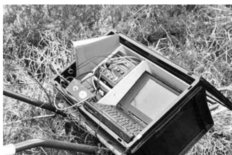
Fig. 8: Radarconsole mit Computer zur Datenerfassung (Foto: P. Staubli).
