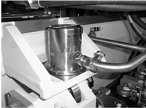
Abb. 6: HLS-Sensoren im eingebauten Zustand
